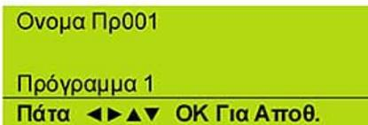
3. Χρησιμοποιήστε τα πλήκτρα [←] & [→] για να μετακινηθείτε στις θέσεις των χαρακτήρων που αποτελούν το όνομα του αυτοματισμού. Χρησιμοποιήστε τα πλήκτρα [↑] & [↓] για να επιλέξετε χαρακτήρες. Για σβήσιμο όλων των χαρακτήρων προς τα δεξιά πατήστε [OFF].
