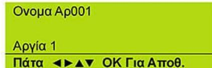
3. Χρησιμοποιήστε τα πλήκτρα [←] & [→] για να μετακινηθείτε στις θέσεις των χαρακτήρων που αποτελούν το όνομα του σετ διακοπών. Χρησιμοποιήστε τα πλήκτρα [↑] & [↓] για να επιλέξετε χαρακτήρες. Για σβήσιμο όλων των χαρακτήρων προς τα δεξιά πατήστε [OFF].
